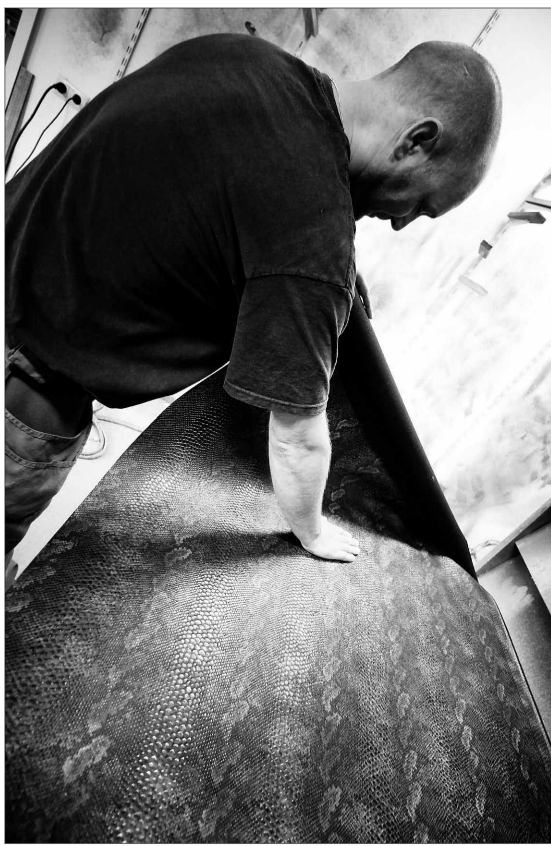
Gijs Sparidaens bekleedt de buitenzijde van een mdf-plaat met leer.
